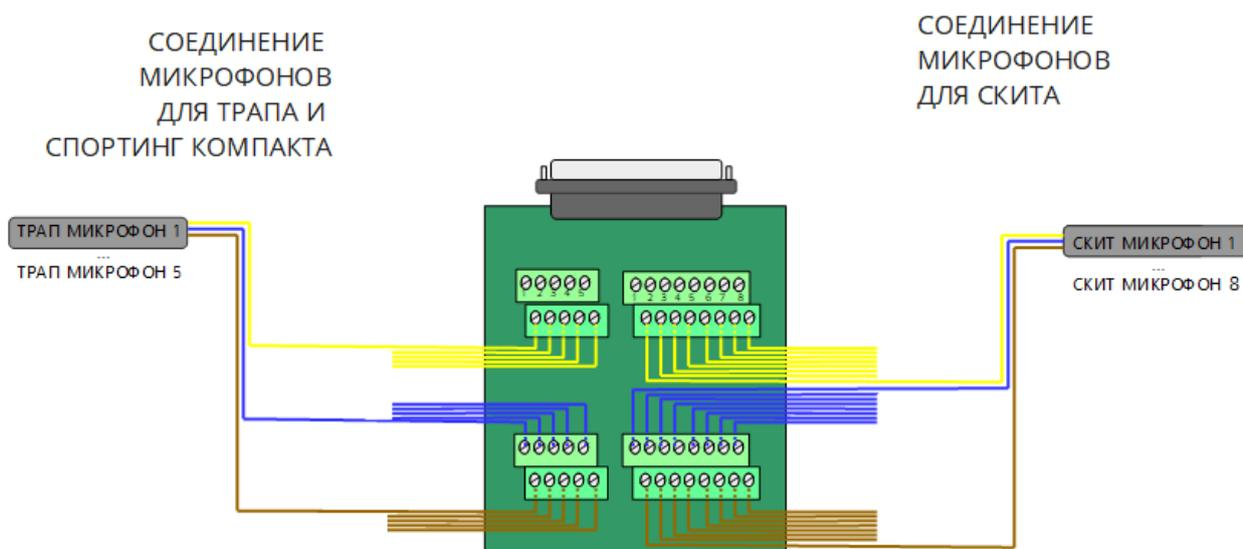
2. При использовании микрофонов с **4-жильным микрофонным кабелем** (например, микрофонами LAPORTE) провода должны быть подключены следующим образом:
