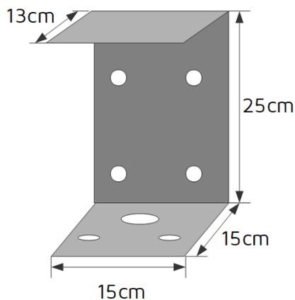
Размеры задних корпусов наружных выходов
