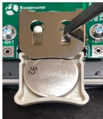
Um die Batteriespannung zu überprüfen, verwenden Sie bitte ein Voltmeter und testen Sie den Batteriestand, während Sie die Taste drücken. Wenn es niedriger als 4V ist, tauschen Sie bitte die Batterie aus!
