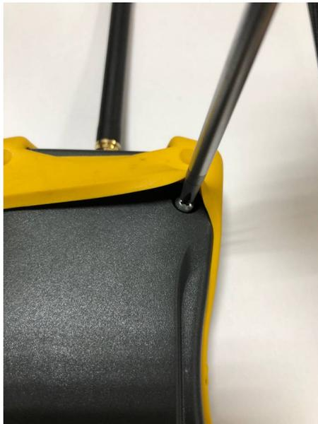
Achten Sie beim Schließen des Gehäuses darauf, dass die Gummidichtung richtig geschlossen ist.
