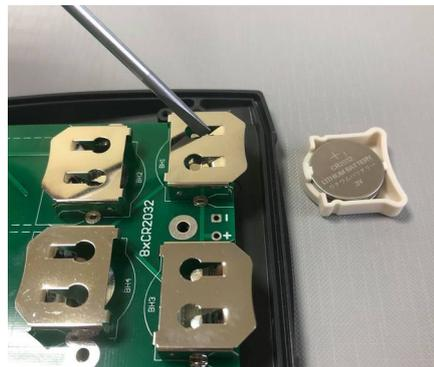
Um die Batteriespannung zu überprüfen, verwenden Sie bitte ein Voltmeter und testen Sie den Batteriestand, während Sie die Taste drücken. Wenn es niedriger als 4V ist, tauschen Sie bitte die Batterie aus!
