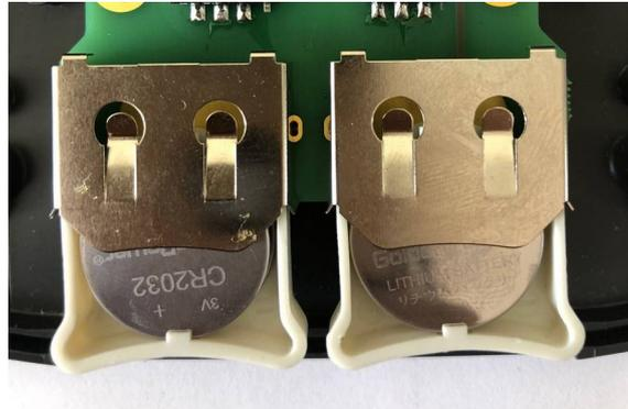
Vor dem Einlegen der Batterie drücken Sie vorsichtig auf die Clips des Batteriehalters, um den Kontakt zwischen dem Gerät und der Stromquelle zu verbessern.
