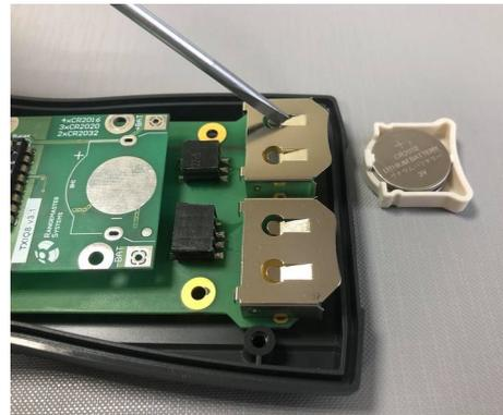
**HINWEIS:** Vor dem Einlegen der Batterie drücken Sie vorsichtig auf die Clips des Batteriehalters, um den Kontakt zwischen dem Gerät und der Stromquelle zu verbessern.
